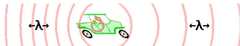
Abbildung 11: Ausbreitung von Schallwellen (rosarote Kreisbögen), die von einem fahrenden hupenden Auto erzeugt werden. In Fahrtrichtung werden die Schallwellen zusammengedrückt. Daher ist ihre Wellenlänge \lambda_1 etwas kleiner als \lambda (vgl. Abb. 10, Wellenlänge der Schallwellen, die von einem stehenden, hupenden Auto erzeugt werden). Entgegengesetzt zur Fahrtrichtung werden die Schallwellen auseinandergezogen. Ihre Wellenlänge \lambda_2 ist daher etwas größer als \lambda . (Bild: Wikipedia, Monika Maintz)
