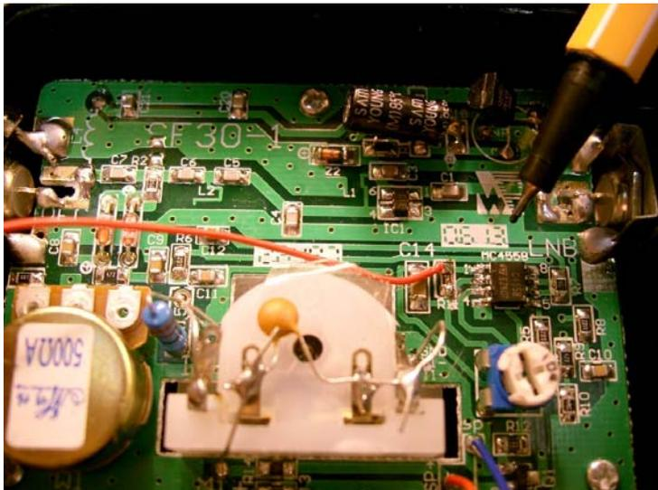
Rot isoliertes Drähtchen (Pluspol) wird am Widerstand R11 (gleich Ausgang des Operationsverstärkers C4558) wie gezeigt angelötet
