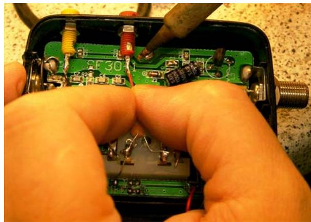
Ins Plastikgehäuse werden zwei Löcher zur Aufnahme je einer Telefonbuchse geschmolzen und vorsichtig mechanisch vergrößert. Die Telefonbuchsen, die wie die Drähtchen möglichst auch rot und schwarz sein sollten (hier musste eine gelbe Buchse verwendet werden), werden eingesetzt und mit den jeweiligen Drahtenden verlötet.
