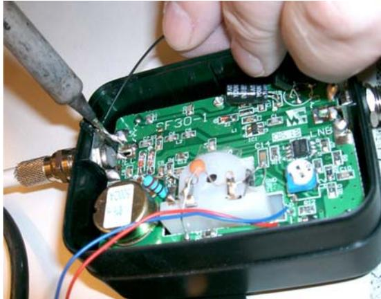
Schwarz isoliertes Drähtchen (Minuspol) wird an F-Buchse angelötet (Verbindung zum Drahtgeflecht des Koaxialkabels)
